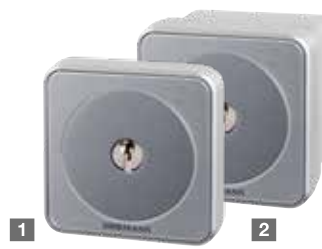
Contacteur à clé 1 STUP 50 2 STAP 50 Exécution à encastrer ou en applique, incluant 3 clés, boîtier en zinc moulé sous pression en aluminium blanc RAL 9006 avec plaque en acier inoxydable
