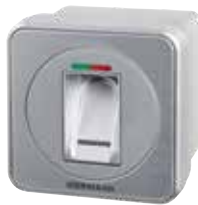
Lecteur d'empreinte digitale FL 150 2 fonctions, commande par empreinte digitale, jusqu'à 150 empreintes digitales mémorisables, boîtier en zinc moulé sous pression en aluminium blanc RAL 9006 avec plaque en acier inoxydable
