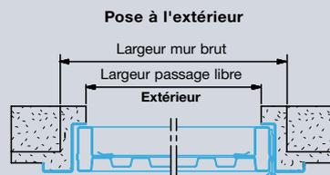
En cas de pose à l'intérieur le profil de seuil doit être enlevé. L'évacuation de l'eau vers l'extérieur doit être assurée.
