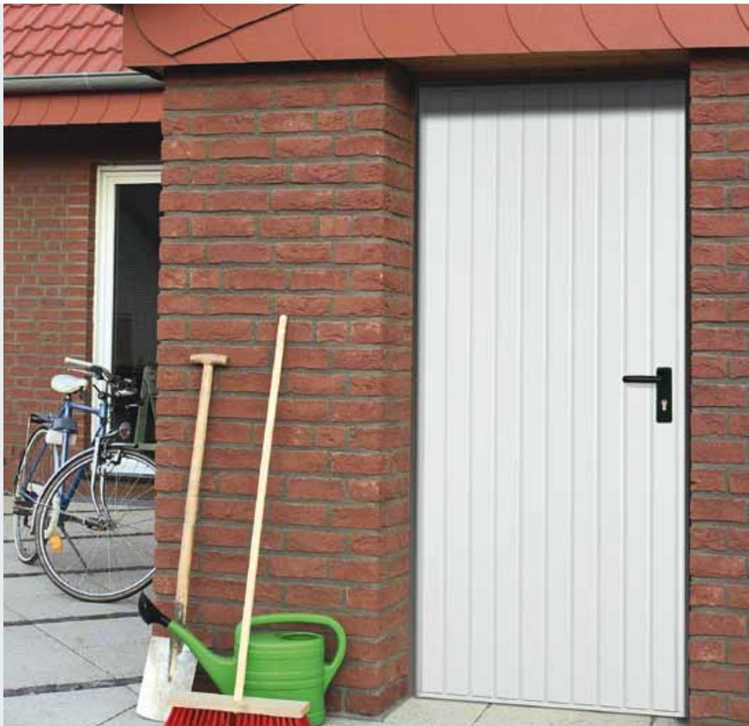
Les blocs-portes à simple paroi sont utilisés comme porte de service intérieure et extérieure, ou comme porte de cave. Le panneau rigide est composé d'une tôle en acier galvanisé à chaud, prépeint à base de poudre de couleur blanche (comparable au RAL 9016). Un joint sur les 4 côtés assure une étanchéité parfaite. Sur option, un système de verrouillage trois points renforce votre sécurité. Les blocs-portes SK offrent des caractéristiques d'aspect et de solidité exceptionnelles.
